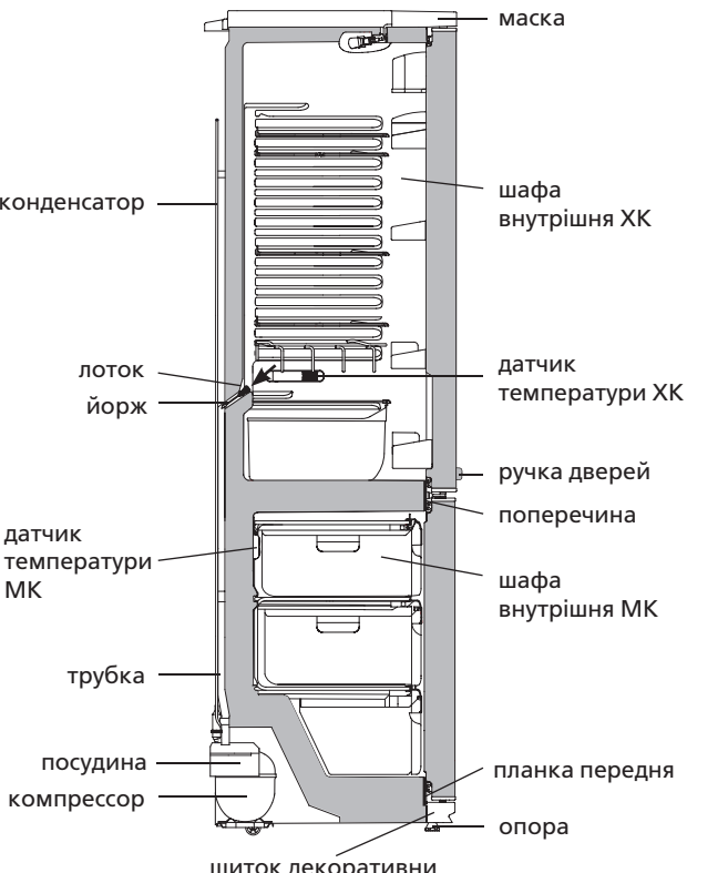
Рисунок 7 — Схема зливу талої води із ХК
